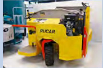
Auf Kundenwunsch ist ein Zusatz für das Auflösen von Maisballen erhältlich, mit dem auch Futterzusätze beigemischt werden können. Die hydrostatische Lenkung ermöglicht ein Wenden an Ort, ein besonderer Vorteil bei minimalen Platzverhältnissen und Futterachsen ohne Durchfahrt. Über kurz oder lang wird der «Rucar» in wasserblauer Farbe und wohl auch mit Elektro-Antrieb auf den Markt kommen.
