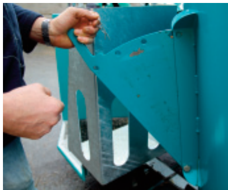
Die mechanische Gegenschneide lässt sich in drei Positionen verstellen und verhindert das Mitdrehen des Futters mit der Schnecke.
