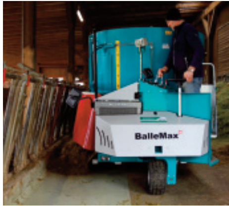
Das Futter wird über eine Rutsche nahe am Futtertisch abgelegt.
