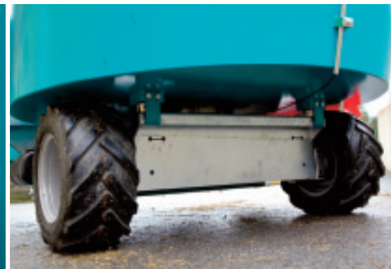
Beim myMischer SD 500 werden auch die beiden Hinterräder angetrieben. Das erleichtert das Manövrieren der Maschine auf nicht planbefestigten Böden.
